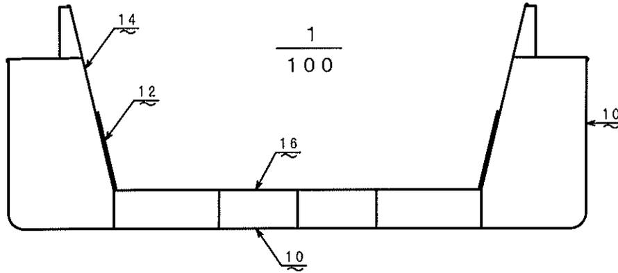
船体寸法  $40.0 \times 11.0 \times 3.3 + (1.0)$  m m m m
